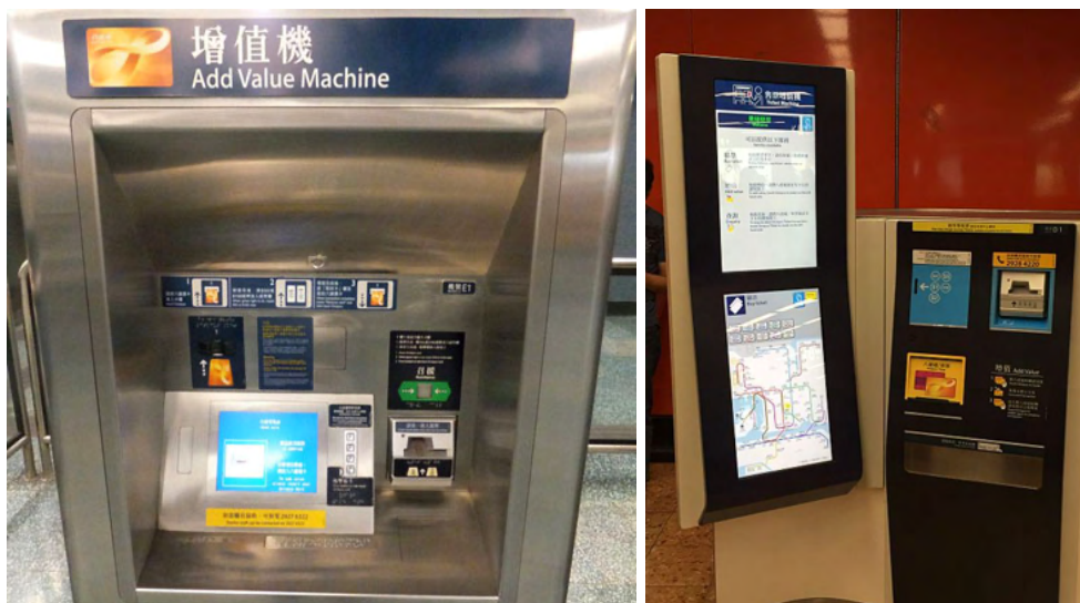
ตู้แบบสอดบัตร (ซ้าย), ตู้แบบวางบัตร (ขวา)
